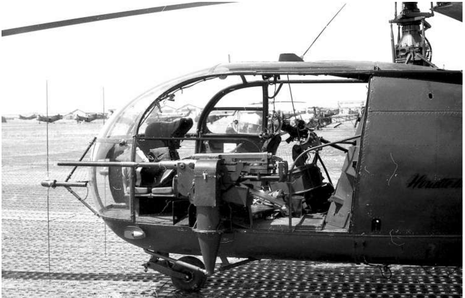
Alouette III armée du canon Mauser MG 151, en expérimentation au sein du PMAH de la 19 e DI (photo Pierre Lalanne).
