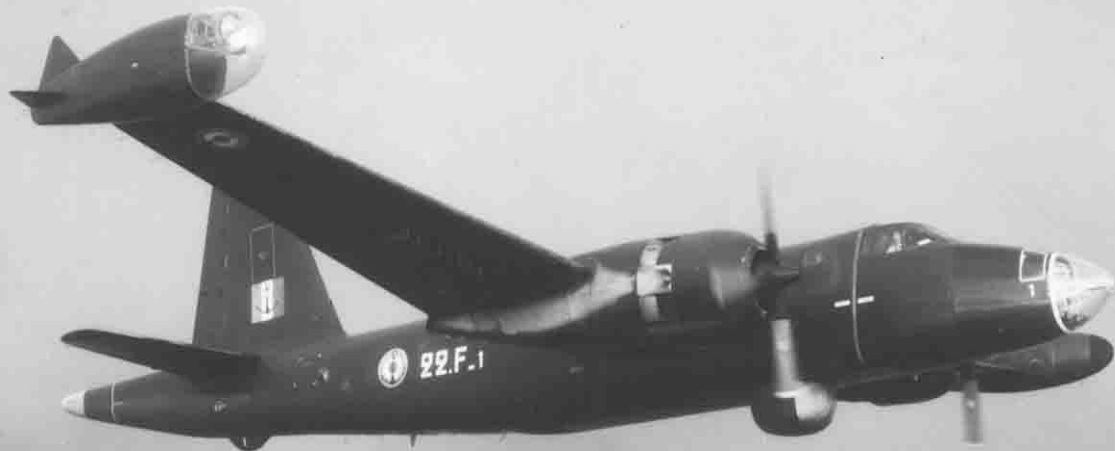
Neptune de la flottille 22F avec le radôme du radar baissé
