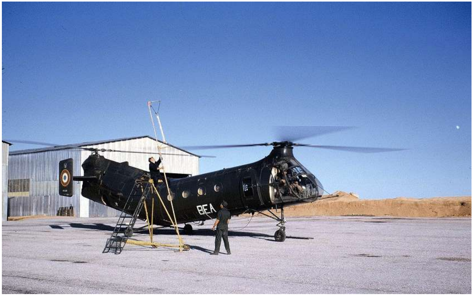
FR89/BEA, du CEMO. Réglage des pales sur la Banane à In Amguet, en 1965 (photo via Ange Baggioni).
