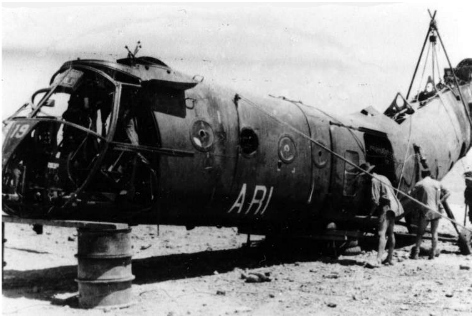
FR93/ARI du GH N°2. Accidenté à Tamentout, le 1 er mai 1960, à la suite d'une perte de tours au posé, le pilote couche l'appareil sur le côté. Reversé à la 674 e CRALAT pour 4 e échelon (photo Jacques Barraquier).
